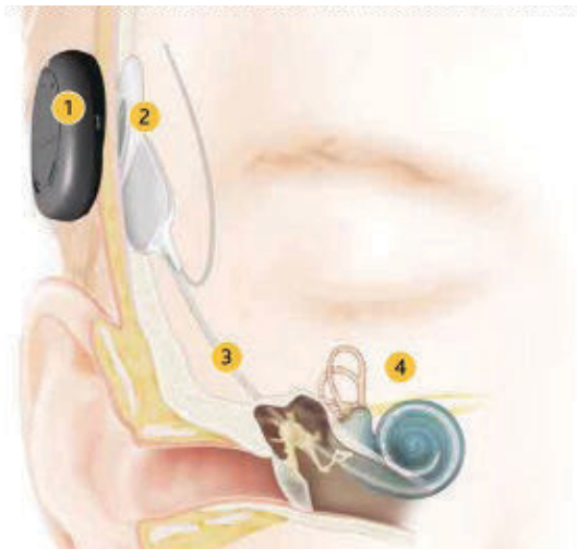
Mô phỏng thiết bị điện cực ốc tai khi cấy ghép
